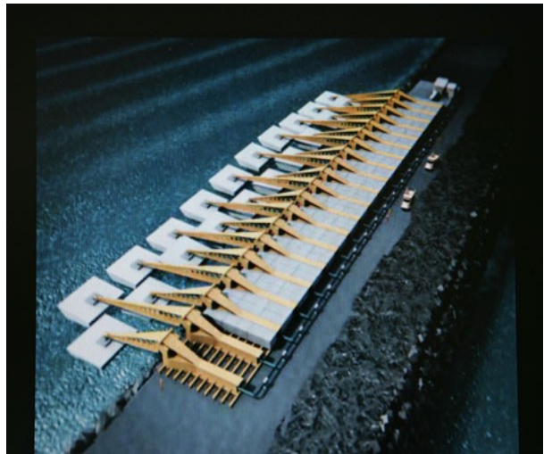
Protótipo em laboratório: usina de ondas, a primeira da América Latina, para produção de energia
