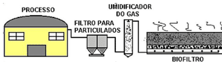
Figura 1 – Desenho esquemático do processo de biofiltração
